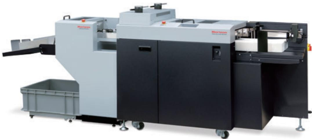
型抜き装置 RD-3346 + 分離装置 SPC-3346
