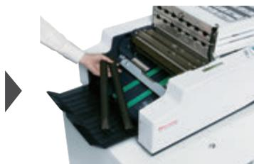
バックル部を倒してローラを外し、清掃または交換します。
