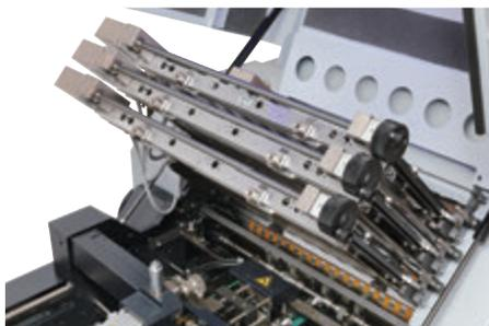
し、折りズレを防ぎます。2種類の異なるストッパー形状のバックルの他、用紙長さが異なっても瞬時に折形を変更できるダイナミックフォールドバックル\*も取り揃えています。\*オプション
