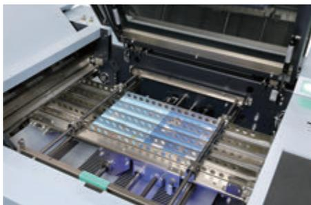
独自設計の用紙搬送部は、静電気による搬送トラブルを抑え、薄紙から厚紙まで幅広い種類の用紙を傷つけることなくスムーズに搬送します。上面に追加したカバーで静音性と安全性が向上しました。各ガイドは自動設定されるためセット替えごとにカバーを開ける必要はありません。二枚差しが発生した場合は、クラッチが機能して用紙を搬送部で止めるため、ヤレ紙を発生させません。
