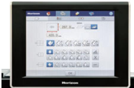
12.1インチの新型タッチパネルディスプレイにより、グラフィカルで直感的な操作が可能です。用紙サイズや折形などをタッチパネルに入力することで、本機がすべて自動で設定されます。ジョブに応じた調整や設定内容は、最大999ジョブまでメモリー登録することが可能なため、リピートのジョブも効率的に生産可能です。(従来機のAFC-566FKTでメモリー登録した情報を本機へ引継ぐことも可能です。)
