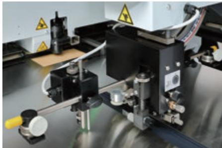
新開発のサクションヘッドにより、セットアップの簡易化と安定給紙を実現しました。サクションヘッドと横吹きエア-\*で用紙のさばきとピックアップを確実にを行います。サクションヘッドの高さとサバキエアーの風量は、用紙の状態に応じて調整できるため、幅広い種類の用紙を安定して給紙できます。
