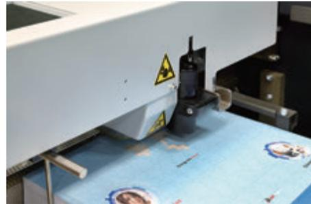
高品質のポリウレタン製給紙ロータにより、用紙を傷つけることなく、高速給紙を実現します。エアの吸引角度を調整できるため、安定した給紙が可能です。二枚差し検知には超音波センサーと光電センサーを標準装備し、用紙の条件によって使い分けが可能です。
