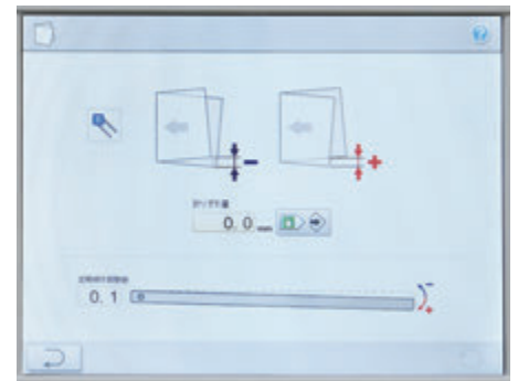
折ずれの微調整は折りずれパターンや折りずれ量を入力するだけで流し台定規の傾きが自動セットされます。
