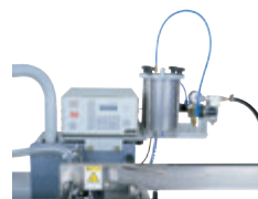
写真は、のり付け装置制御部です。
