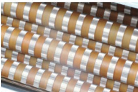
最小 20 mm の小物折りを可能にし、長時間の作業においても、常に安定した折り精度を実現します。ウレタンとスチール製のコンビネーションローラは、用途に合わせて発泡ウレタンと硬質ウレタンの 4 種類から選択可能です。
