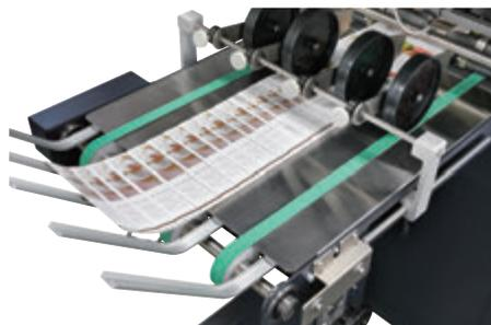
ショートコンベヤSCV-406 (オプション) は、省スペースレイアウトに最適な搬出コンベヤです。スピード調整や高さ調整が可能のため、搬出後のハンドリングが容易で、効率的な作業が可能です。その他にもナイフユニットやスタッカーなどのオプションを豊富に取り揃えており、用途に合わせて選択できます。
