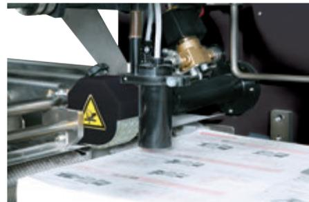
高品質ポリウレタンロータ製給紙ロータにより、用紙を傷つけることなく、高速給紙を実現します。給紙タイミングや給紙間隔などの調整はタッチから行えます。サクションヘッドを使用せず、給紙ロータのみで給紙することで、小サイズの用紙も安定して給紙します。
