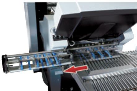
搬出ベルトユニットは外側へスライドできるため、筋入れローラの位置調整が容易です。
