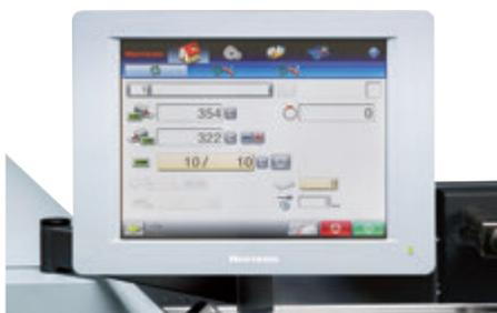
タッチパネルにより、グラフィカルで直感的な操作が可能です。用紙サイズや折形などをタッチパネルに入力することで、自動で設定されます。ローラギャップは、5 $\mu$ m単位、バックルストッパーは0.1 mm単位でタッチパネルから調整が可能です。ジョブに応じた調整や設定内容は、最大200ジョブまでメモリー登録することが可能なため、リピートのジョブも効率的に生産できます。
