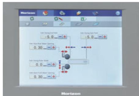
ミーリングガイド、ニッピング設定、表紙位置合わせ、クランパー幅、筋位置等の設定調整は、タッチパネルからの入力で自動でセットされます。
