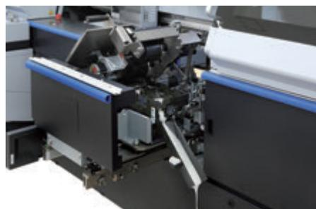
タンク内ののりを、専用ドレインを取り付けて流し出します。タンクとドラムは、テフロンコーティングがされており残ったのりは冷却後、簡単に剥がすことができます。
