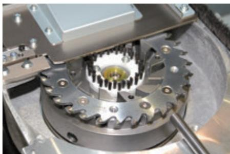
インバーター制御により、タッチパネルからノッチングカッターのピッチが変更可能です。ミーリングガイド幅は、自身の厚さに応じて自動でセットされます。ミーリングは、強力なモーターによるレベリングカッターとノッチングカッターにより、折丁の製本物も確実に背加工を行います。
