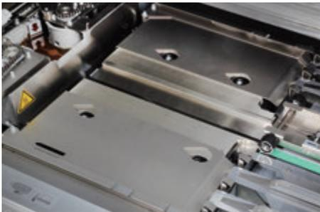
製本条件に合わせて、ニッピング時間、ニッピング待ち時間、ニッピング高さがタッチパネルから設定ができます。強力なニッピングで、高い製本強度を実現します。
