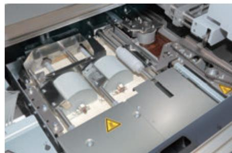
背のリタンクは、ローラ高さ、ワイパー開き量を、タッチパネルから調整することが可能です。横のりは可動ワイパー機構の採用で、のり塗布量、のり切のタイミングが制御可能です。LED照明を搭載しており、メルトタンク内の状態確認も容易に行なうことができます。
