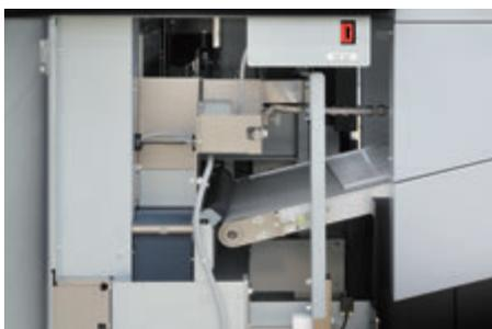
デリバリーガイド幅は、冊子受け取りテーブルが自動昇降し、冊子を高い位置で受け取るため、衝撃による形くずれが発生しません。
