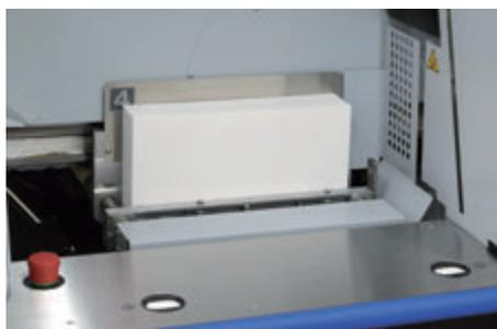
クランパー幅は、タッチパネルからの入力で自動設定されます。本身を強力に掴んでいるため、ミーリング部やニッピング部でのズレを防ぎます。レベルプレートの高さを変更することで、切り込み量は4mmまで調整可能です。本身投入口は、安全ビームが標準装備されており、安全に作業を行うことができます。
