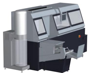
製本稼働時は、ミーリングされた切り屑を排気袋が吸引し、待機時は、排気袋内のエアが抜けるため、ミーリング屑が切り屑袋に落下します。ミーリング屑の取り扱いには、切り屑袋を交換するだけです。
