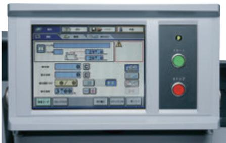
10.4インチのタッチパネルで設定や操作を行います。処理形態(中綴じ、平綴じ、コーナー綴じ、折り)はワンタッチで切り替えることが可能です。微調整値などの設定内容は、最大200ジョブまでをメモリー登録することが可能なため、リピートのジョブを効率的に生産できます。動作中に微調整を行えるため、仕上がり状態を確かめながら調整することが可能です。丁合機を接続している場合は、丁合機の操作も可能です。
