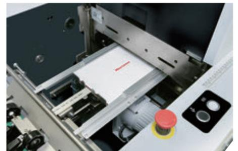
用紙条件に合わせて突き揃え回数や突き揃えストローク量などの調整が可能です。用紙に応じた調整が可能なため、幅広い種類の用紙を確実に突き揃えます。
