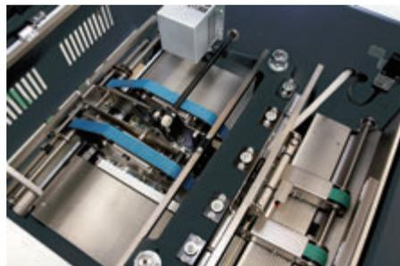
ナイフの駆動にサーボモータを採用し、高速かつ高品質な小口断裁を実現します。上下のベルトで挟んで冊子を搬送することで、搬送を安定化しました。断裁部で切り落とした用紙はエアでダストボックスに吹き落とします。鋳造加工された断裁部は耐久性に優れ、安定した品質を長期間維持します。
