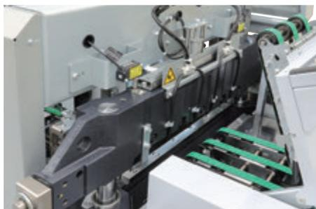
上下のベルトで冊子を挟んで SPF-40 から水平に搬送されるため、小口刃による傷を防ぐ機構に設計されています。サーボモーターによる搬送機構と小口方向からの突き揃え機構が正確に位置決めをし、冊子の小口を断裁します。また、SPF-40 のタッチパネルに用紙サイズを入力するだけでガイドは自動で設定されます。
