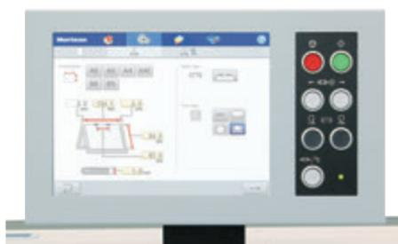
12.1インチの大型カラータッチパネルはアイコンベースにUIをさらに進化させ、使いやすさを追求しました。用紙サイズと製本サイズを入力するだけで各部が10秒以内(A3→A4仕上がり)に全自動セットされます。突き揃え時間の調整など、用紙の状態や製本サイズに合わせた設定も自動で行われます。最大999ジョブまでメモリー登録が可能のため、リピートの仕事に素早く対応できます。
