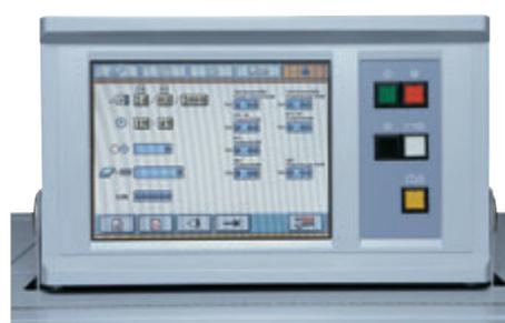
カラータッチパネルディスプレイに用紙サイズと製本サイズを入力するだけで各部分が 30 秒以内 (A3 → A4 仕上がり) に自動セットされます。5 段階のスピードモードや突き揃え時間の調整など、用紙の状態や製本サイズに合わせて設定することも可能です。最大200ジョブまでメモリー登録が可能のため、リピートの仕事に素早く対応できます。
