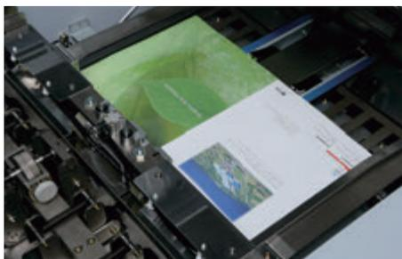
丁合機から給紙された用紙を確実に突き揃えて位置決めをします。位置決めをされた用紙は筋入れ部で正確に筋入れ処理が行われ、シャープな製本物ができあがります。
