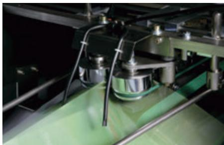
筋入れ加工された用紙は SPF-30S に搬送される途中で筋に合わせて正確に折り加工されます。折りプレスローラによる連続的な折り加工によってタイトな折りが仕上がります。
