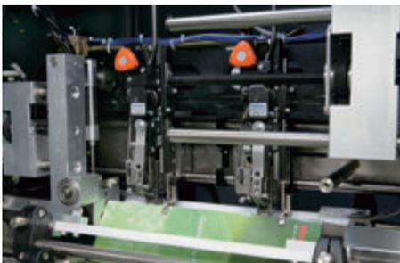
最大製本厚さ 10 mm (70kg 相当の上質紙約 50 枚) の中綴じ冊子の作成が可能です。天地方向で突き揃えした後、ステッチャーヘッドのセンタリング機構で位置決めをするため、バラツキなく正確にステッチが行えます。また、ステッチワイヤーの送り出し量は、製本厚みに合わせて自動で設定されます。オプション装置の増設により、4 個ステッチやループステッチなど、多様な形態にも対応できます。
