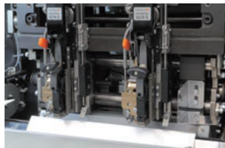
サイズ設定、ステッチの左右バランス調整、ステッチ検出(ループステッチにも対応)まで自動化しました。また、ステッチ可能範囲がSPF-30S\*よりも拡大しました。ループステッチや4個ステッチに加え、センターステッチもオプションで選択可能です。
