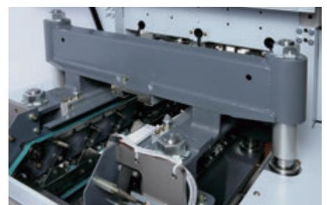
冊子の天地を断裁します。切り屑はカッターホルダーから出る強力エアと可動式シュートでスムーズに取り出されます。オプションのセンターカット装置の装着時は、二丁掛け製本にも対応します。
