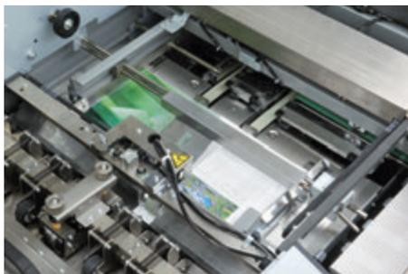
サイズのセットは従来の手動調整箇所・着脱ガイド等を排して全自動になりました。また、画期的な集積機構を採用し、従来不安定であった条件でも安定した高速処理ができます。
