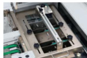
※ページ検証システムとトラッキングシステムでは使用するコードリーダーと取付部品が異なります。BVS-SL50Dは1D/2Dコードに対応、BR-SPF50は2Dコードに対応します。
