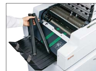
バックル部を倒してローラを外し、清掃または交換します。
