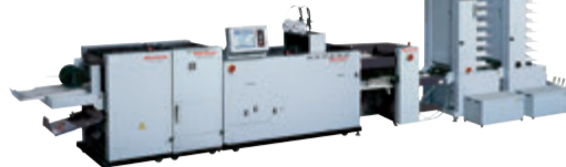
中綴じ製本システム VAC-2000 + ST-40 + SPF-200A + HP-200A + FC-200A
